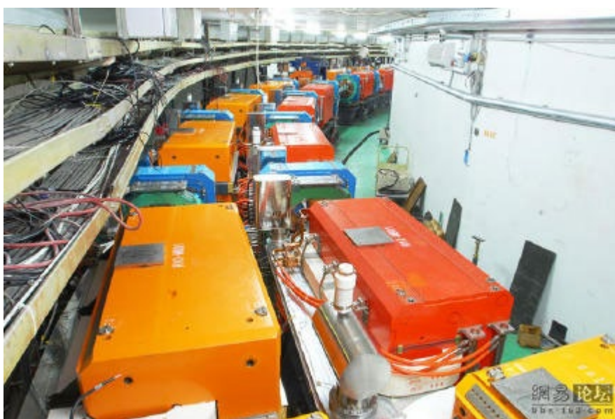
BEPC II 储存环隧道内 B 铁单元、Q 铁小单元及单独 Q 铁
